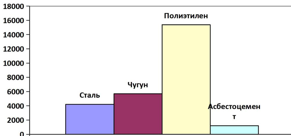
Протяженность сетей водоснабжения р.п. Ближне-Песочное составляет 22 333,5 м. Подавляющее большинство сетей проложено из чугунных труб в 1972-1983 годах. В настоящее время на таких сетях часто возникают утечки ввиду ветхости раструбных соединений. Сети поселка закольцованы, имеются не большие тупиковые участки. С целью повышения надежности водоснабжения поселка необходима замена ветхих сетей и их закольцовка.
