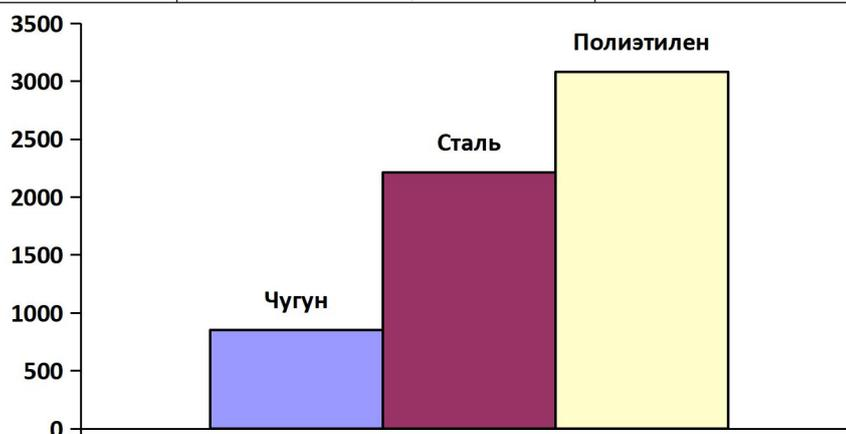
Протяженность сетей водоснабжения в д. Новая Деревня составляет 3991 м. Сети проложены в 1985 – 1987 годах. Утечки возникают только на стальных и чугунных трубопроводах ввиду высокой степени износа. Для надежности водоснабжения необходимо заменить аварийные участки на полиэтиленовые трубы.
