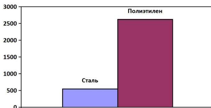
Протяженность сетей водоснабжения с.п. Дружба составляет 5447 м. Основная часть сетей построена в 1979 – 1990 годах из стальных труб и в настоящее время нуждается в замене. Для обеспечения надежного водоснабжения необходимо выполнить замену стальных труб на полиэтиленовые.
