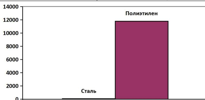
Сеть водоснабжения р.п. Шиморское проложены в основном из полиэтиленовых труб (26 495 м) в 2002-2016 годах. Такие участки имеют минимальный износ, утечек и аварий на них не возникало, таким образом, в замене данные сети не нуждаются. Но около 50% сетей проложено из асбестоцементных, стальных и чугунных труб, процент износа которых на текущий момент достигает 80%. Такие сети необходимо заменить на полиэтиленовые и выполнить закольцовки.
