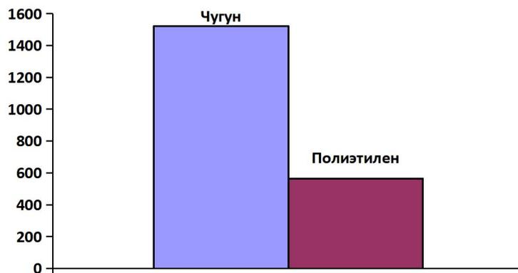
Сети водоснабжения с. Чупалейка проложены в 1976 году из стальных, полиэтиленовых и чугунных труб протяженностью 5046 м. Ввиду длительного срока эксплуатации и высокой степени износа, на стальных и чугунных трубопроводах возникают утечки. Данные участки необходимо заменить.
