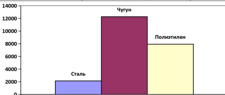
Протяженность сетей водоснабжения р.п. Виля (Проволочное) составляет 10 238 м. Большая часть сетей проложена в 1981 году из чугунных труб и имеет большой износ. На данных сетях регулярно возникают утечки. Сеть поселка кольцевая, имеются тупиковые участки. С целью повышения надежности, необходимо заменить аварийные участки и выполнить закольцовку сетей.
