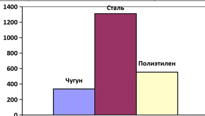
Протяженность сетей водоснабжения с. Полдеревка составляет 2086 м. Сети проложены в 1973 году из чугунных и полиэтиленовых труб. Ввиду длительного срока эксплуатации, износ сетей составляет 50-60%. Утечки возникают на чугунных трубах в раструбных соединениях. Для надежности системы водоснабжения необходимо заменить чугунные трубы на полиэтиленовые.
