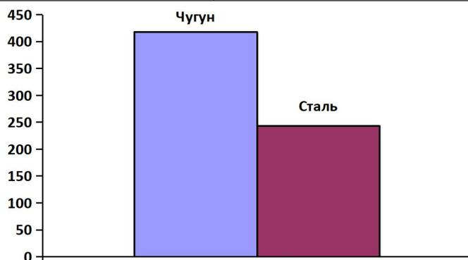
Протяженность сетей водоснабжения д. Покровка составляет 2237 м. Сети построены в 1983 – 2004 годах. Износ чугунных и стальных трубопроводов более 50 %, возникают прорывы и утечки на данных участках. Требуется капитальный ремонт сетей.
