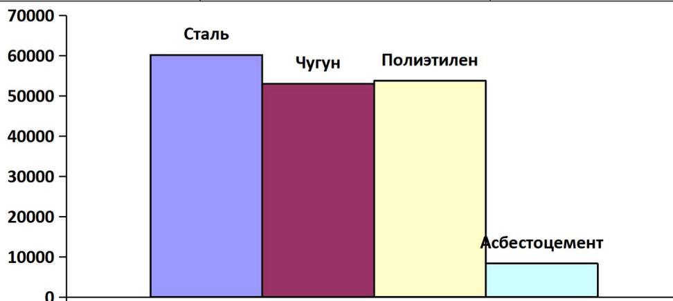
Сети водоснабжения города закольцованы с системой водоснабжения с. Мотмос. Протяженность сетей водоснабжения с. Мотмос составляет 17 268 м. Сети проложены из стальных, чугунных и полиэтиленовых труб. Большая часть сетей закольцована, но имеются и тупиковые участки. Ввиду длительного срока эксплуатации стальных и чугунных труб, на сетях возникают аварийные ситуации. Данные сети нуждаются в замене.
