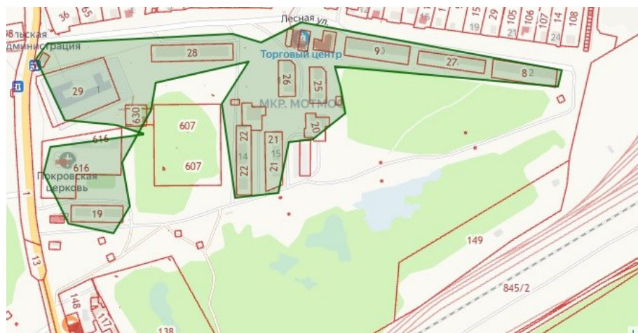
Зона действия котельной м-н Мотмос
